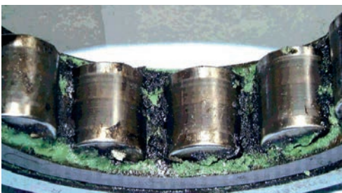
Деградация смазки, вызванная прохождением электрического тока
