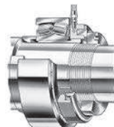
Figura 6. Porca HMV e porca de batente especial colocação numa manga de ressalto
