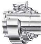
Figura 8. Ghiera HMV ed anello di bloccaggio in posizione per sbloccare una bussola di trazione
