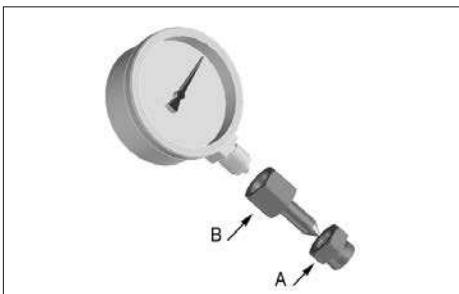
Když je konektor A téměř utažený, otočte tlakoměr do správné polohy.
