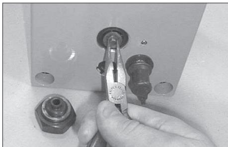
Αν ο αεροκινητήρας είναι υπερβολικά θυροβώδης και υπάρχει διαρροή αέρα από τον αεροκινητήρα, σημαίνει ότι η πίεση αέρα που παρέχεται στη σειρά THAP...E είναι πολύ υψηλή. Η ενσωματωμένη βαλβίδα ανακοπής ροής αέρα δεν επιτρέπει τη χρήση πίεσης αέρα πάνω από 7 bar. Μειώστε την πίεση αέρα σε 7 bar. Η χρήση πίεσης αέρα πάνω από 7 bar οδηγεί σε απώλεια συμπιεσμένου αέρα.
