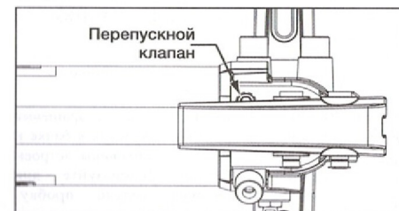
Рисунок 15 – переключный клапан (P-77, P-80, P-801 и P-84).
