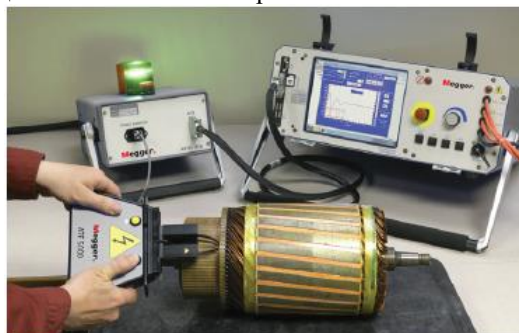
Испытание якоря при помощи приспособления ZTX и шупа коллектора ATF5000.
