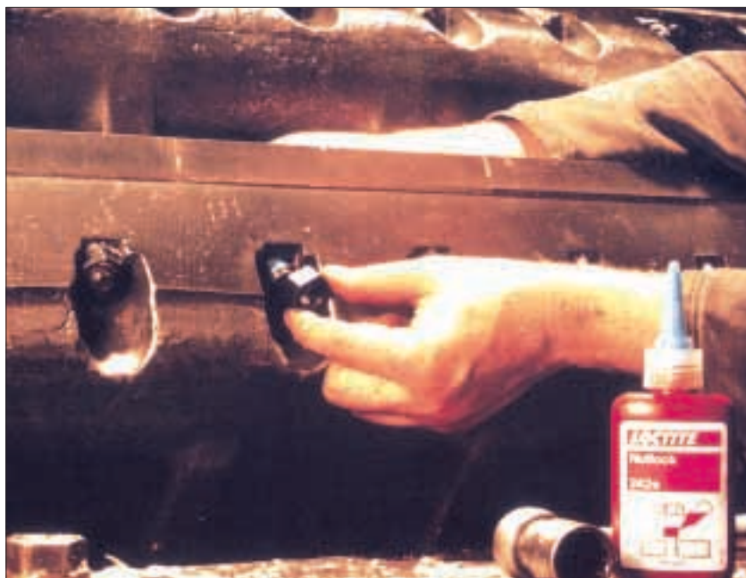
Винты ножей для резки пленки фиксировались самостопоорящейся гайкой и отвинчивались под действием вибрации. Теперь Локтайт 243 надежно фиксирует гайки.
